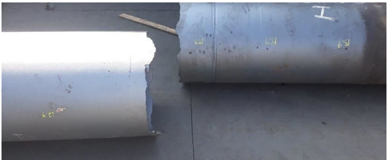
Gebrochenes Drehrohr zur Untersuchung der Schadenursache Ergebnis der Untersuchung: Lokale Überhitzung
